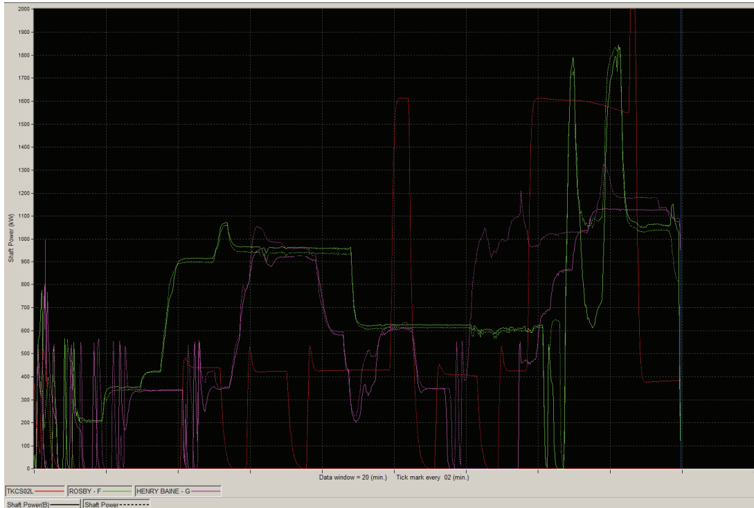
Illustration 57 Puissance aux arbres du navire et des remorqueurs en fonction du temps
