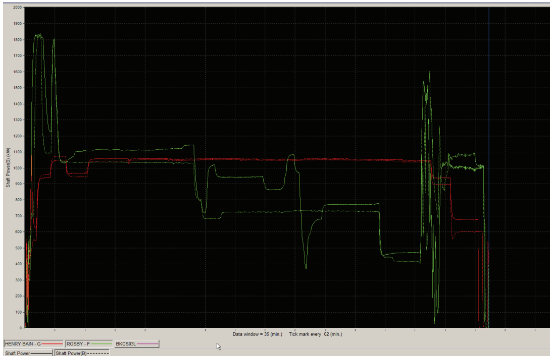
Illustration 79 Puissance sur les arbres des remorqueurs en fonction du temps
