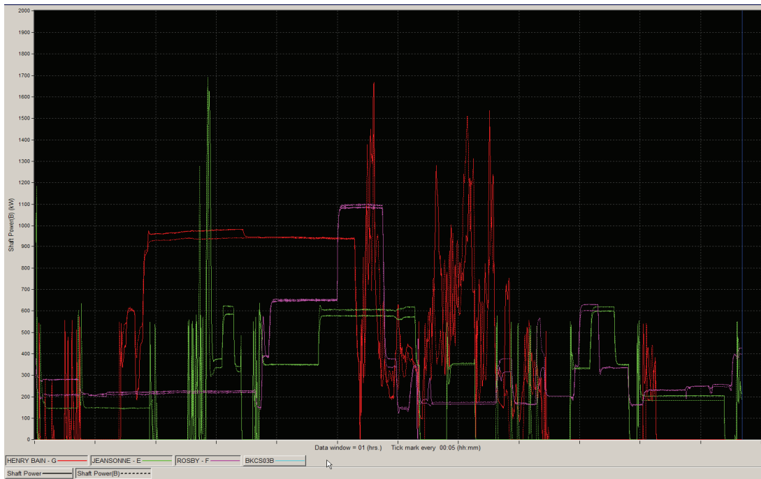
Illustration 14 Puissance sur les arbres des remorqueurs en fonction du temps
