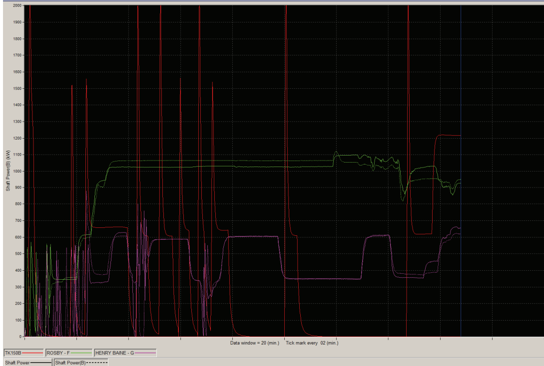
Illustration 71 Puissance sur les arbres en fonction du temps
