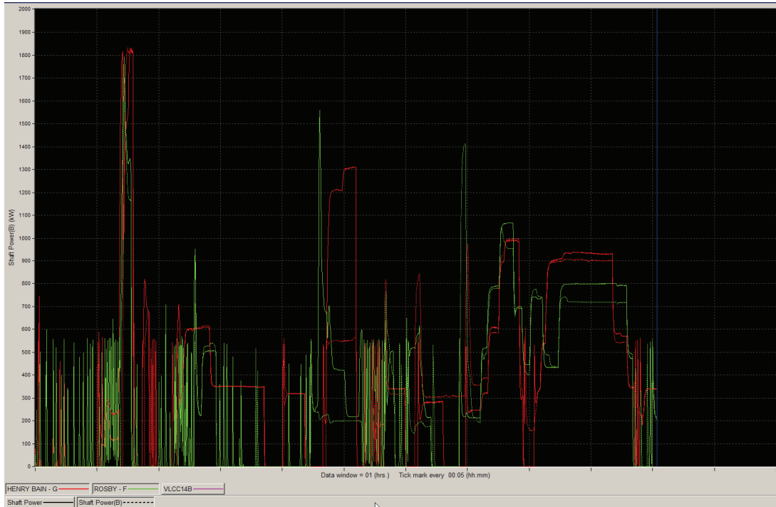
Illustration 85 Puissance sur les arbres des remorqueurs en fonction du temps
