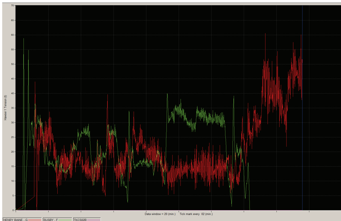
Illustration 62 Tension sur les aussières des remorqueurs en fonction du temps
