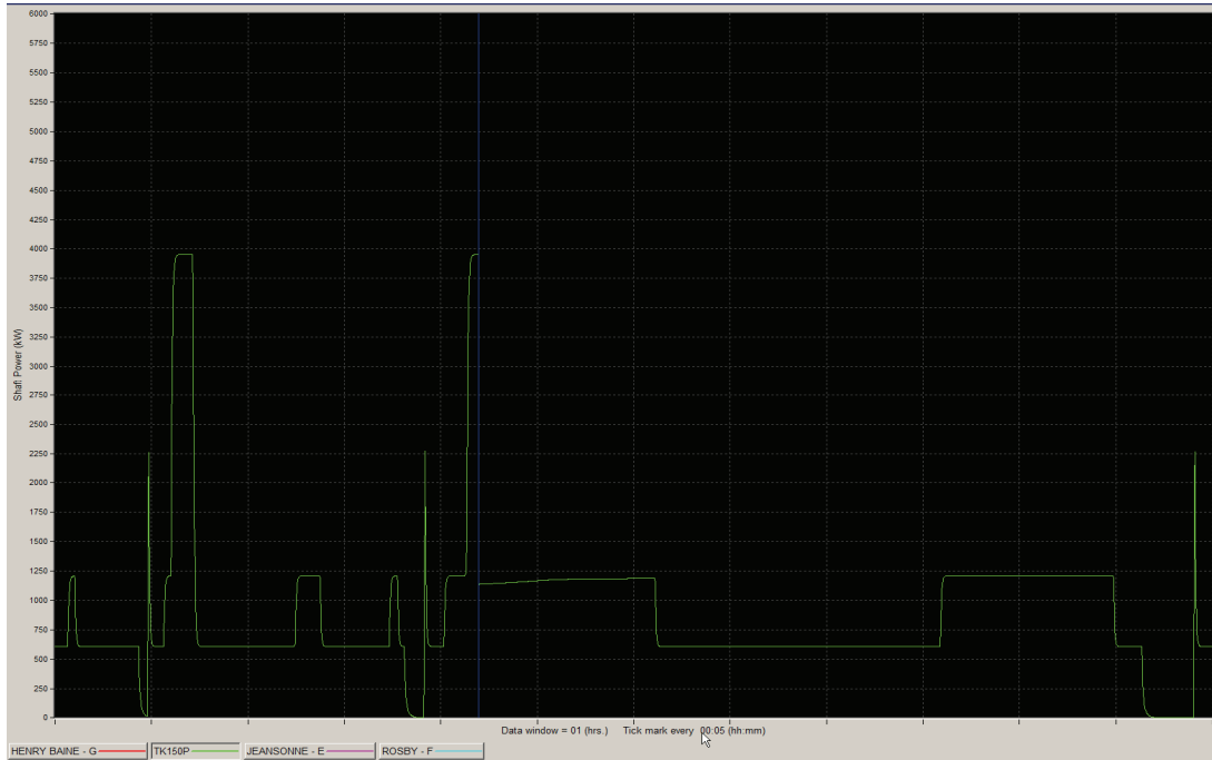
Illustration 3 Puissance sur l'arbre en fonction du temps
