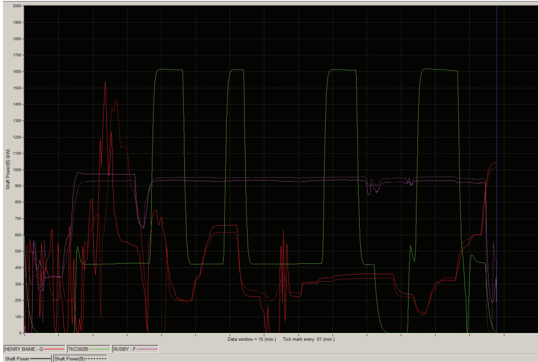
Illustration 63 Puissance sur les arbres du navire et des remorqueurs en fonction du temps
