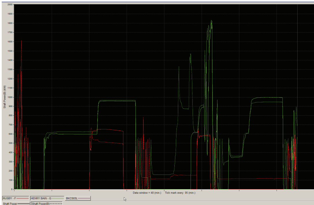
Illustration 75 Puissance sur les arbres des remorqueurs en fonction du temps
