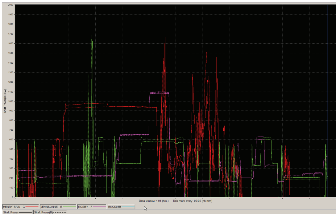
Illustration 12 Puissance sur les arbres des remorqueurs en fonction du temps
