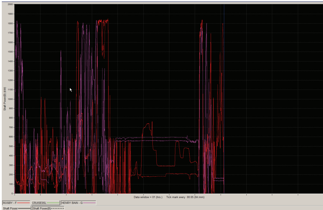
Illustration 91 Puissance sur les arbres des remorqueurs en fonction du temps
