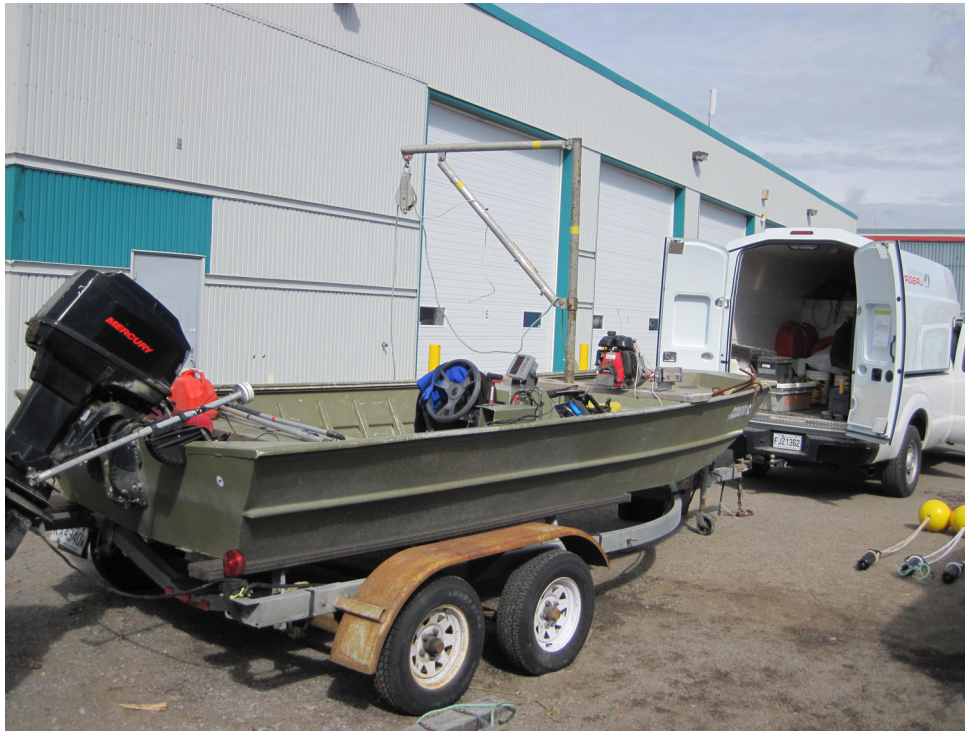
PHOTO 1 — Embarcation et système de levage pour l'installation des récepteurs
