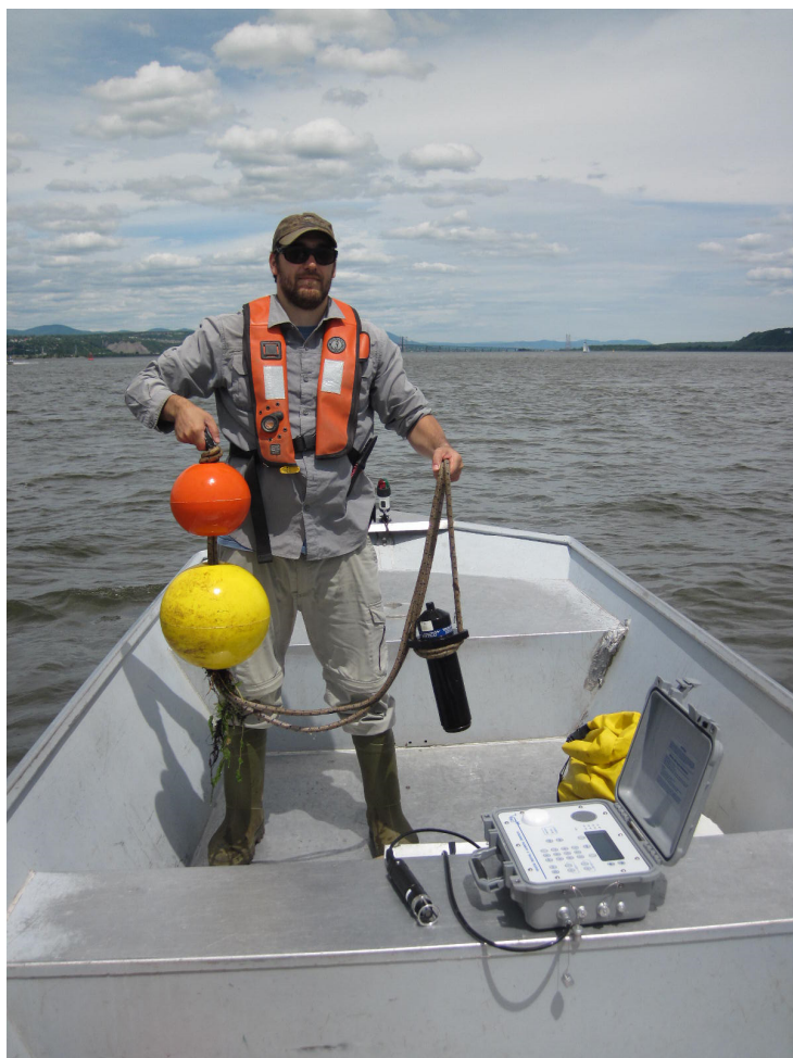
PHOTO 5 — Récupération d'un récepteur et téléchargement des données
