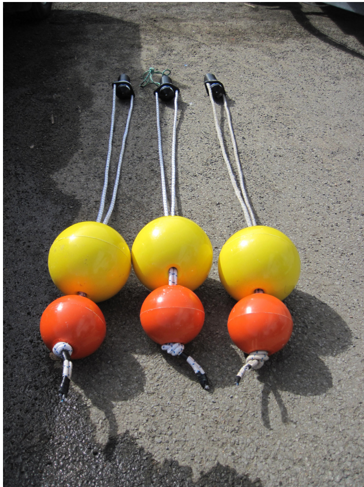
PHOTO 3 — Système de déclenchement à distance, incluant les bouées permettant aux récepteurs d'atteindre la surface
