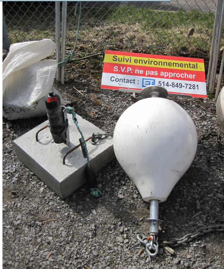
PHOTO 2 — Récepteur et bouée de sécurité avertissant les plaisanciers de ne pas approcher
