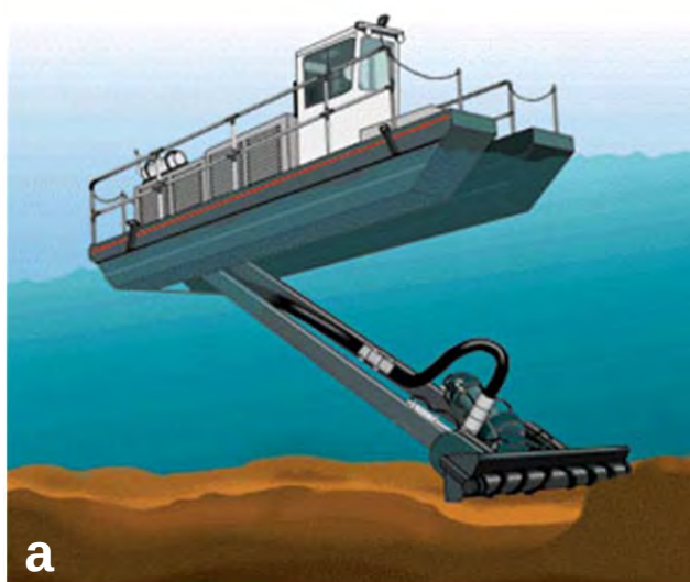
Figure 1 a) Exemple de drague hydraulique et b) Exemple de drague mécanique
